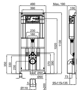
**Telaio + cassetta da incasso per vaso sospeso.** Installazione su **parete leggera** con kit di fissaggio 100041103 - N398160000 e canotti per il vaso.
