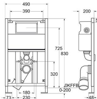
**Telaio + cassetta da incasso per vaso sospeso.** Altezza 830 mm. Installazione su **parete leggera** con kit di fissaggio 100041103 - N398160000 e canotti per il vaso. Altezza ridotta. Per installazione sotto la finestra.
