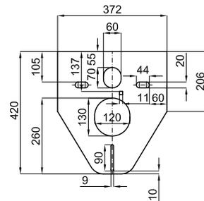
**Guarnizione per protezione ed isolamento acustico, per l'installazione tra il WC / bidet sospesi e le piastrelle.**
