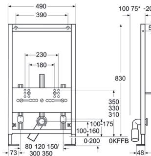
**Telaio per bidet sospeso.** Altezza 830 mm. Installazione su **parete leggera** con kit di fissaggio 100041103 - N398160000. Piastra-gomito per installare tubi flessibili. Altezza ridotta. Per installazione sotto la finestra.
