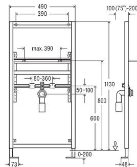
**Telaio per lavabo sospeso.** Installazione su **parete leggera** con kit di fissaggio 100041103 - N398160000.
