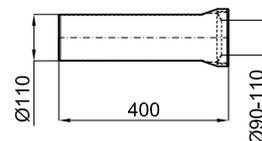
**Raccordo scarico orizzontale 40 cm.** Indicato per vasi con uscita orizzontale oppure orientabile quando si desidera realizzare l'uscita orizzontale ed è necessario un tubo più lungo. Ad esempio nel caso del vaso Essence quando si usa la cassetta con il serbatoio interno.
