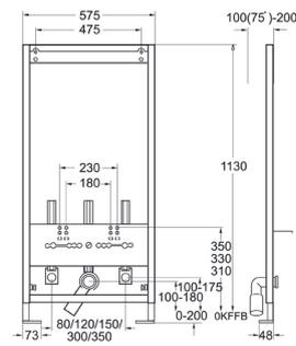
**Telaio per bidet sospeso.** Installazione su **parete leggera** con kit di fissaggio 100041103 - N398160000. Piastra-gomito per installare tubi flessibili.
