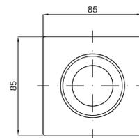
**Placca con pulsante pneumatico singolo.** Installazione su telaio Project Line. È compatibile solo con gli elementi 100100299 - N398840034, 100047927-N364850002, 100047933-N364850001
