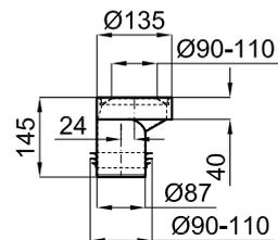
**Manicotto eccentrico raccordo vaso uscita verticale** che consente un leggero spostamento laterale. Per collegare il vaso con uscita verticale al tubo di scarico da 90 a 110 mm.
