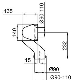
**Gomito eccentrico uscita verticale** con vite prigioniera di fissaggio a parete e guarnizione multipla
