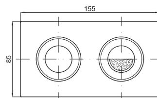
**Placca con pulsante pneumatico doppio.** Installazione su telaio Project Line. È compatibile solo con gli elementi 100100299 - N398840034, 100047927-N364850002, 100047933-N364850001
