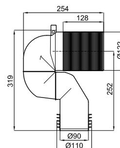
Curva scarico regolabile vaso S-V
