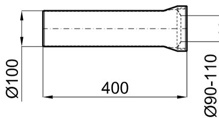
**Tubo connessione orizzontale** diam. da 100 mm., lungo 400 mm. in PVC, per vasi da scarico orientabile o orizzontale
