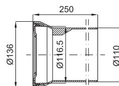
**Raccordo scarico orizzontale.** Indicato per vasi con uscita orizzontale oppure orientabile quando si desidera realizzare l'uscita orizzontale.
