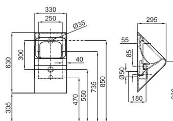
**SOFT - Orinatoio con entrata acqua posteriore e fissaggio laterale con fissaggi 100041212 - N420150000. Il sifone 100041265 - N450600001 è incluso. Si può installare su parete solida o leggera con telaio per orinatoio 1000041105 - N398295600.**
