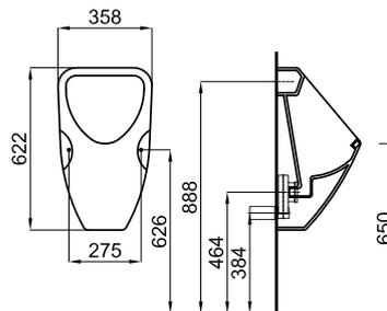
**CITY - Orinatoio con alimentazione parte posteriore e fissaggio frontale** con fissaggi 100040452 - N301150000. Il sifone 100041316 - N45060001 è incluso. Si può installare su parete solida o leggera.
