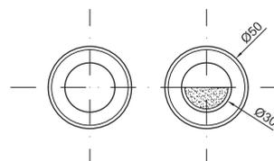
**Pulsante pneumatico doppio.** Installazione su telaio Project Line. È compatibile solo con gli elementi 100100299 - N398840034, 100047927-N364850002, 100047933-N364850001
