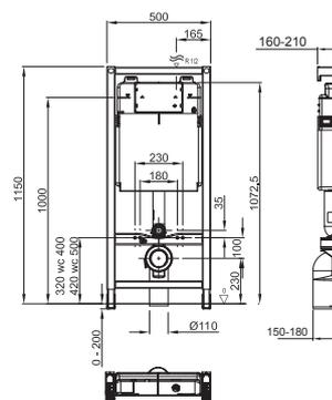
**Telaio + cassetta da incasso per vaso sospeso.** Installazione su parete leggera con kit di fissaggio e canotti per il vaso. Entrata acqua superiore o posteriore DX.
