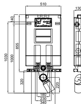
**Supporto + cassetta da incasso per vaso sospeso.** Installazione su **parete in muratura** con kit di fissaggio e canotti per il vaso.
