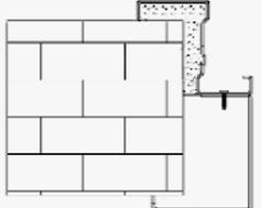
Imbotte MC6 da avvitare al telaio MC3<br>Fino a pareti spessore 150 mm |       |       |
